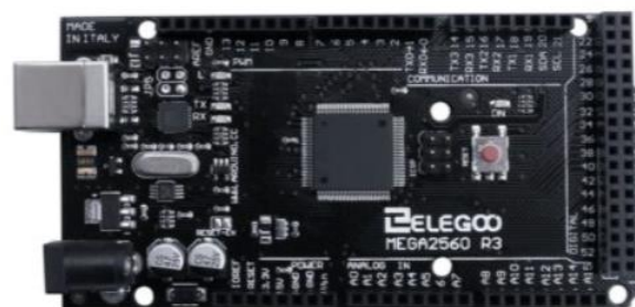
Figure 4. Elegoo Mega Microcontroller.
